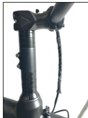
Fig. 13 h. Slide stem onto extender
