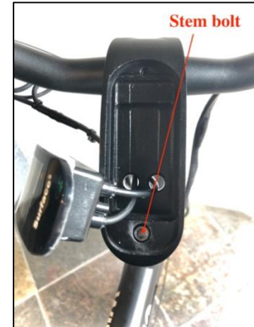
Fig. 13 k. Loosen stem bolt and remove
